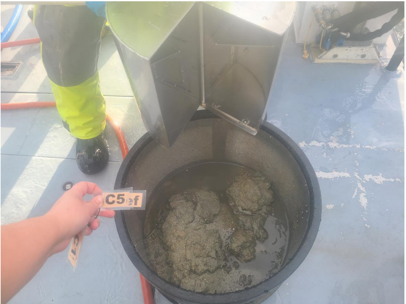
Figur 9-5: Bilde av sedimentet ved C5. Sedimentet besto av sand og skjellsand. Foto: Aqua Kompetanse AS.
