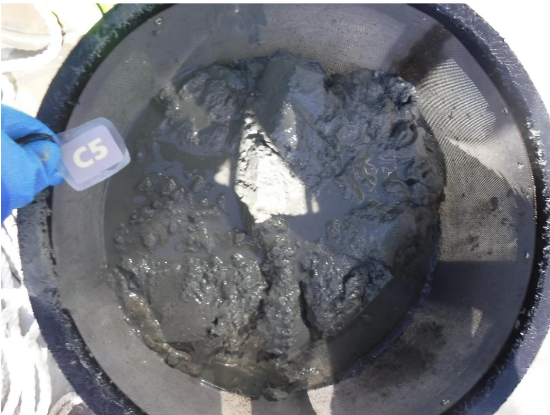
Figur A-4: Bilde av sedimentet ved C5. Sedimentet besto av silt, sand og skjellsand. Prøven hadde en pelittandel på 84,1% (se Eurofins Environment Testing Norway AS rapport i Vedlegg C ). Foto: Aqua Kompetanse AS.
