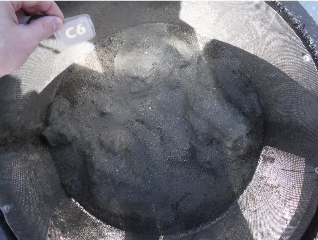
Figur A-5: Bilde av sedimentet ved C6. Sedimentet besto av silt, sand og skjellsand. Prøven hadde en pelittandel på 12,6% (se Eurofins Environment Testing Norway AS rapport i Vedlegg C). Foto: Aqua Kompetanse AS.
