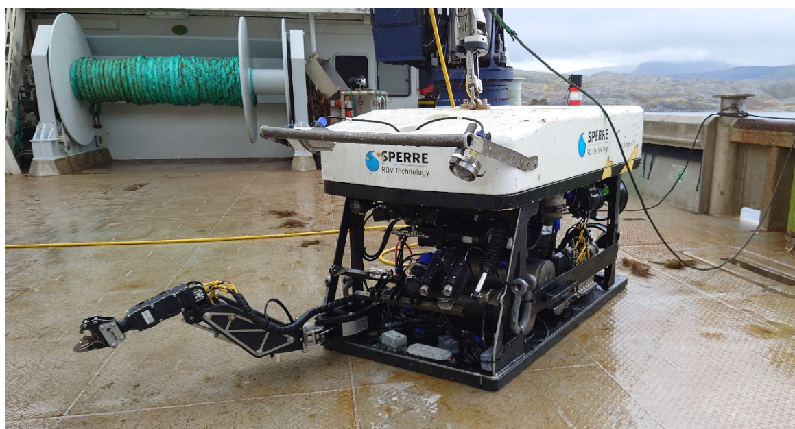
Figur 5. Illustrasjonsbilde av Sperre ROV (type sub-fighter15k) som ble benyttet ved ROV-kartlegging.
